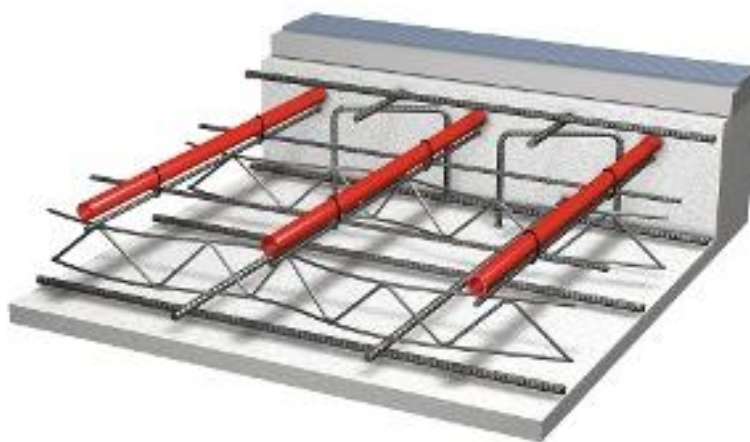
29. ábra – Beton vasalatba elhelyezett fűtési/hűtési csövek
