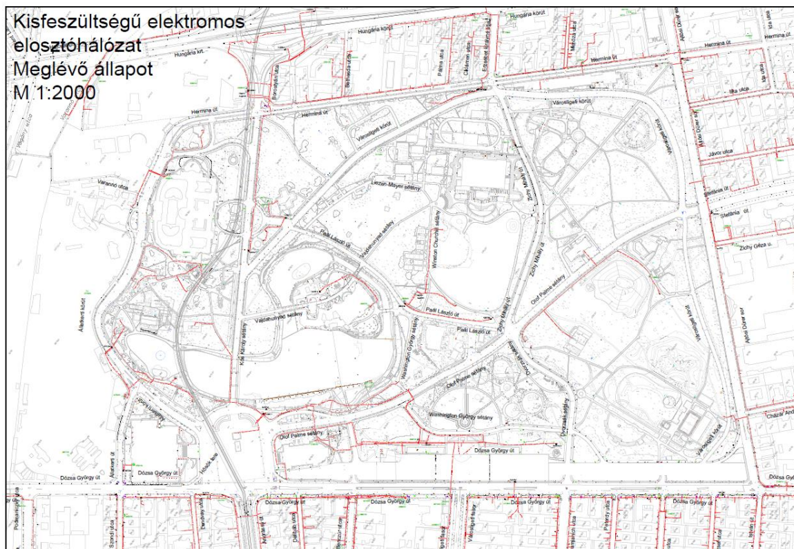
17. ábra Kisfeszültségű elektromos elosztó hálózat meglévő állapot
