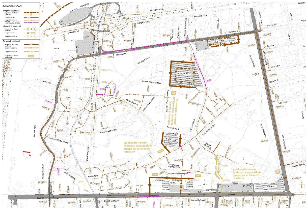
8. ábra Csapadékvíz elvezetés tervezett 2. változat
